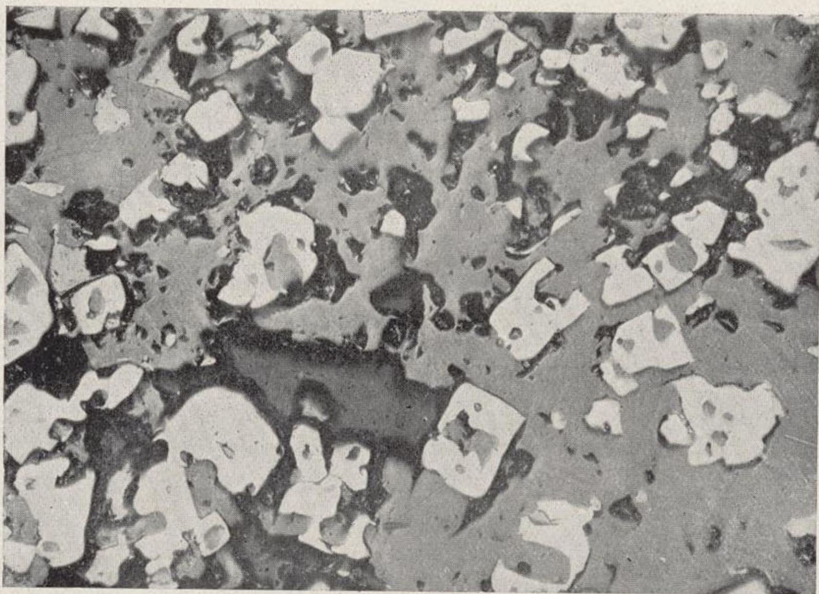
Fot. 36.—(P-60 2). X. 250.—«San Platón».—Metalización hidrotermal en bandas.
